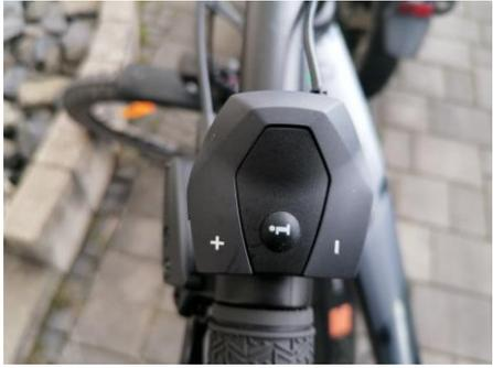
Dies sind die Tasten, mit denen das Display bedient wird.
