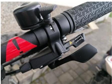
**WICHTIG:** Diese Gangschaltung wird durch **DRÜCKEN** zurückgeschaltet, niemals ziehen!!! Ansonsten den großen, unteren Hebel drücken um in einen kleineren Gang zu wechseln.
