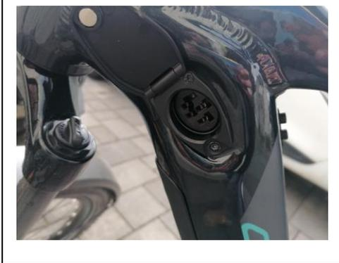
Das Rad lässt sich laden, ohne dass man den Akku ausbauen muß, dazu klappt man die kleine Kappe an der Seite auf und kann so, mit dem beiliegenden Ladekabel das Rad laden, den Ladestatus kann man am Display ablesen.
