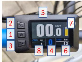
**Schiebehilfe:** lange auf 3 drücken. Nach ca. 2 Sekunden rollt das Rad, solange die Taste gedrückt wird, von alleine mit 5 km/h. Beim Anfahren am Berg oder Schieben eine gute Hilfe. !!! Der Effekt ist ziemlich stark!!!
