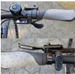
**8-Gang Kettenschaltung** am rechten Griff. Zum Schalten möglichst ohne Last treten, besonders bei hoher Motorunterstützung.
