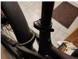
**Sattel:** Mit dem Schnellspanner leicht höhenverstellbar. **Lenker kann leider nicht verstellt werden.**
