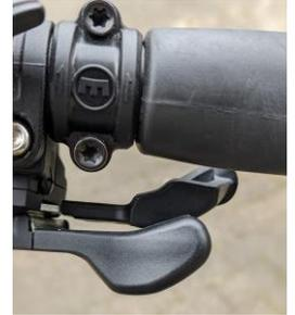
**11- Gang Ketten Schaltung:** vorderer Hebel nach hinten drücken: Es wird in den leichteren Gang geschaltet. Hinterer Hebel nach vorne drücken: geht in den schwereren Gang. Immer während des Tretens schalten! Aber nicht unter Last, also vorausschauend vor dem Anstieg schalten. Welchen Gang man fährt wird NICHT angezeigt. Dafür kommt der Hinweis zum Schalten, den man berücksichtigen sollte.
