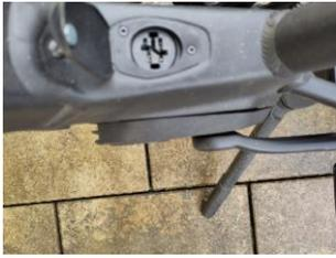
**AKKU laden:** An der Buchse im Rahmen das Ladegerät anschließen. Der AKKU kann nur schwer ausgebaut werden. Deswegen möglichst im Schatten und nicht unter 10 Grad länger draußen stehen lassen.
