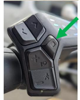
**Multifunktionsdisplay:** Langer Druck auf die On- Taste (roter Pfeil): System startet.
