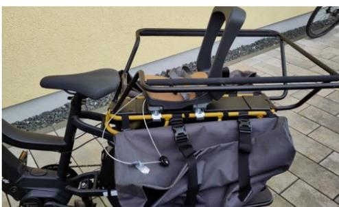
**Gepäckträger:** Er ist für 65 kg zugelassen, wobei die Hauptlast im vorderen Bereich sein soll. Hintere Hälfte max. 10 kg.
