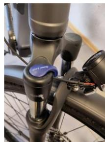
Die Stärke der **Federgabel** kann hier geändert werden oder die Dämpfung auch ganz abgestellt werden. ON und OFF
