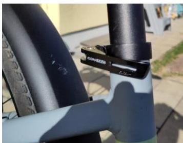
**Sattel:** mit dem Schnellverschluss leicht höhenverstellbar. Stütze ist gekürzt und muss mind. 6 cm im Rohr sein!
